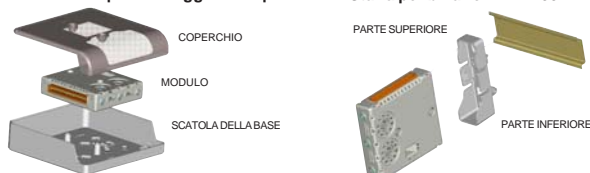
FIGURA 1: METODI DI MONTAGGIO DEL MODULO
